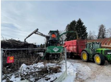
Mit Hilfe von schwerem Gerät des Maschinenrings werden die Äste und Baumstämme zu fertigem Hackgut verarbeitet und in den sogenannten „Hackgutbunker“ an der Energiezentrale gebracht. Hier finden rund 170 Schüttraummeter Platz. „Mit einem Schüttraummeter wird ein Kubikmeter bezeichnet, der mit lose geschüttetem Holz gefüllt ist“, erklärt der Betriebsleiter den Begriff,
