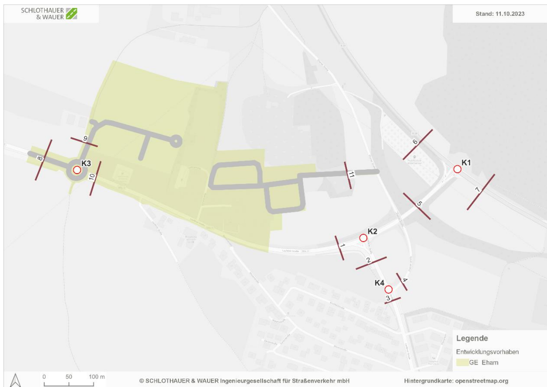
Abbildung 20: Querschnitte für die Berechnungen der Eingangsparameter nach RLS 19 [Quelle: Eigene Darstellung, Hintergrundkarte: openstreetmap.org]
