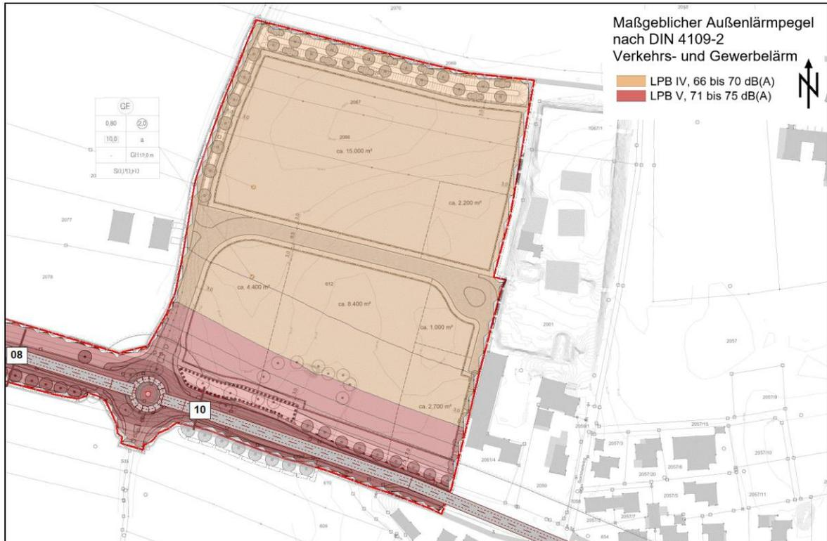
Entsprechend der Lärmpegelbereiche muss die Kombination aller Außenbauteile (Wand, Fenster sowie Fensterzusatzeinrichtungen) des zu betrachtenden schutzbedürftigen Raums ein bestimmtes resultierendes Schalldämm-Maß  $R'_{w,ges}$  erfüllen, welches nach der DIN 4109-1 (2018-01) zu ermitteln ist.
