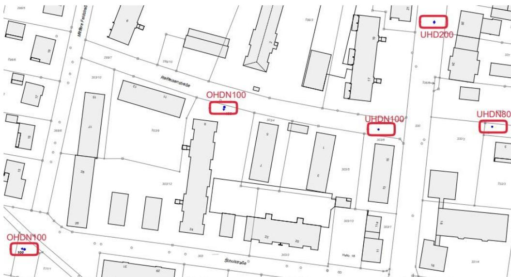
**Abbildung 8:** Auszug aus dem Leitungskataster Sparte Wasser, genordet, ohne Maßstab, (Quelle: Stadtwerke Freilassing)
