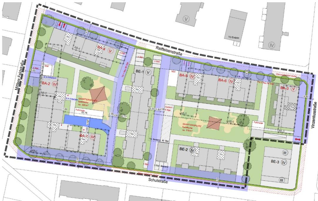
Abbildung 7: Feuerwehrrangflächenplan, genordet, ohne Maßstab (Quelle: Magg Architekten)
