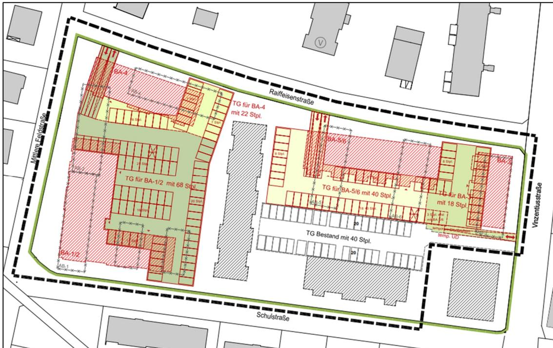
Abbildung 5: Lageplan der geplanten Tiefgaragen /20/
