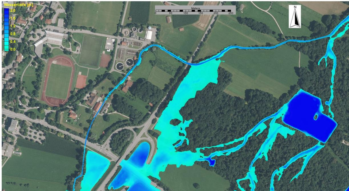
Abbildung 11: Überflutungsfläche  $HQ_{100}$ -Welle 2002/1050 - Bereich Badylon / Kläranlage
