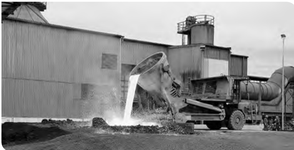
Weltweit Vorreiter: Mit dem selbst entwickelten und zum Patent angemeldeten Schlackebeet haben die Ingenieure der Lech-Stahlwerke die modernste und weltweit einzige Anlage zum umfassenden Schutz des Grundwassers am 01.06.2012 in Betrieb genommen.
